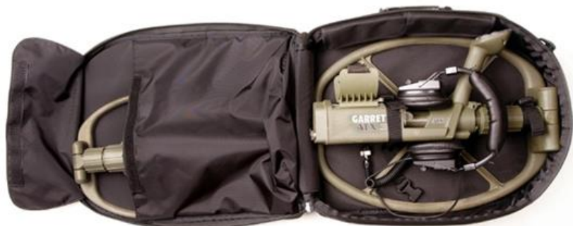
Joonis 5: ATX koos kinnitatud Deepseeker otsimispeaga + DD otsimispea + kõrvaklapid. Märkus: Kinnitage krõpsuribaga Velcro kinnitus.
